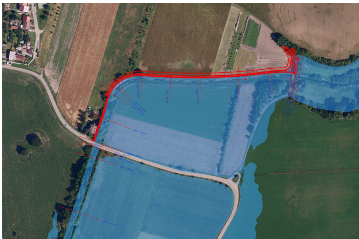
Obr. 4- Záplavové území Dunávky při Q_{100} po provedení PP opatření
