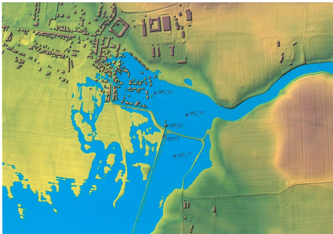
Obr. 3- Záplavové území Dunávky při Q_{100} před provedením PP opatření
